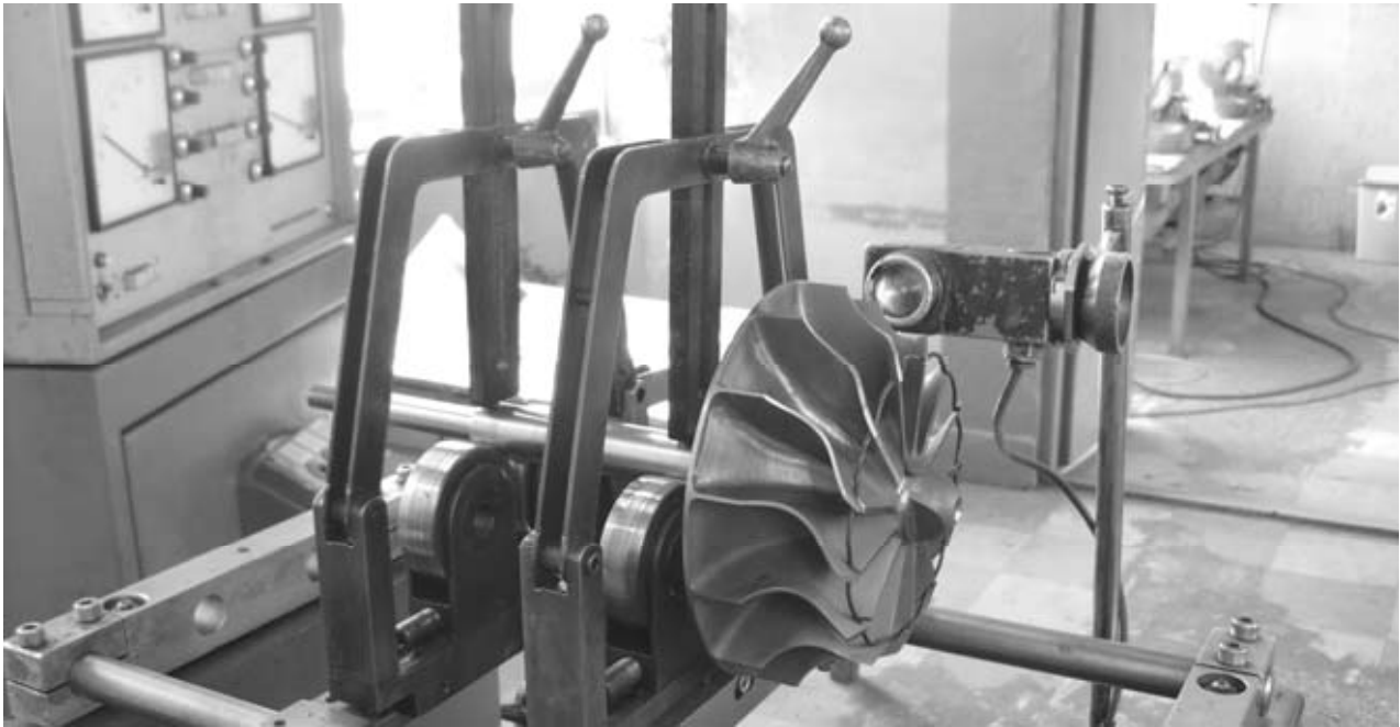
Rys. 2. Wirnik turbiny zamocowany na wyważarce firmy Hofmann Fig. 2. Turbine impeller fixed on Hofmann balancing machine
