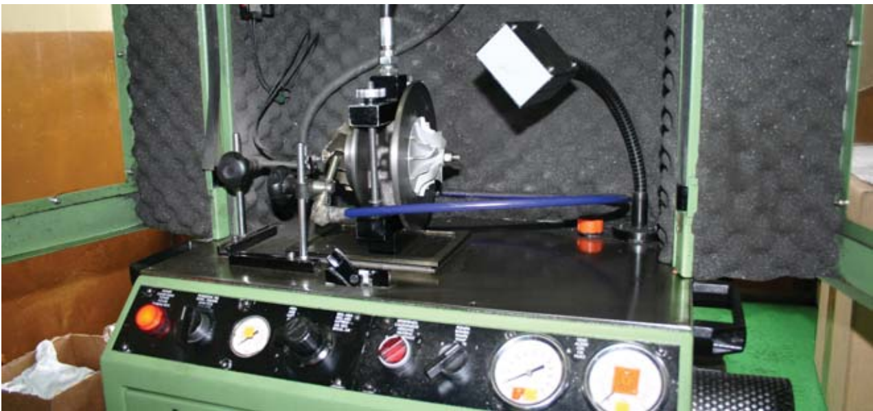
Rys. 4. Wyważarka M2 firmy Turbo Manufacturing Italy Fig. 4. Balancing machine type M2 - Turbo Manufacturing Italy
