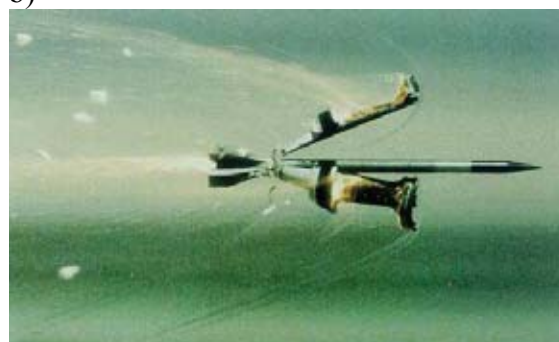
Rys. 4. Podkalibrowy pocisk przeciwpancerny: a) przekrój, b) oddzielanie się sabotu w locie Fig. 4. Silhouettes of some tanks during shooting
