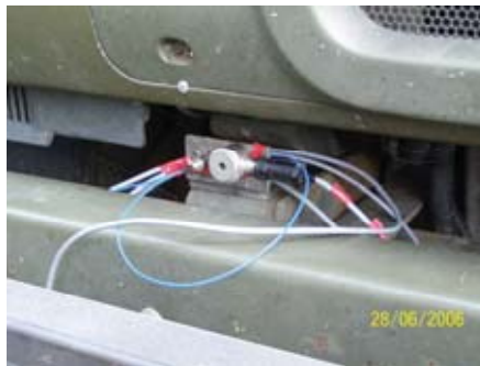
Rys 2. Widok zamontowanych czujników przyspieszeń do ramy pojazdu (czujniki o zakresach \pm 50 g i \pm 10000 g) Fig. 2. Accelerations sensors (range \pm 50g and \pm 10000g )
