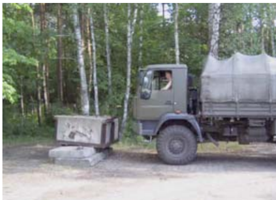
Rys. 4. Najazd na sztywną przeszkodę Fig. 4. Impact at stiff obstacle
