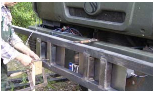
Rys. 5. Określanie sztywności przeszkody podatnej jednoramowej Fig. 5. Determination of stiffness characteristic of flexible obstacle
