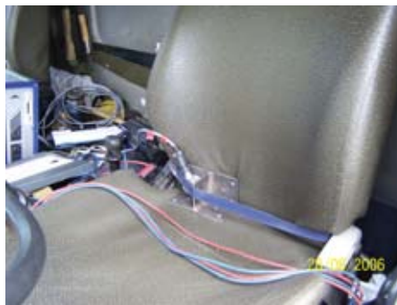
Rys. 3. Widok czujnika na fotelu kierowcy (zakres \pm 50g ) Fig. 3. Acceleration sensors at the driver's seat (range \pm 50 g)
