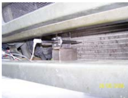
Rys 3. Czujnik przemieszczeń poziomych chłodnicy samochodu Fig 3. Sensor of car's radiator translation
