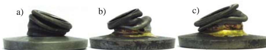
Rys. 10. Postacie deformacji próbek przy obciążeniu dynamicznym (widoki próbek a, b, c odpowiadają wykresom na rys. 9)
