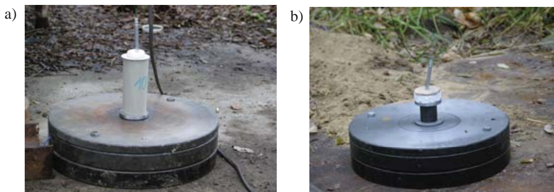
Rys. 4. a) Realizacja wybuchu powietrznego w odległości 100mm od czujnika, b) Realizacja wybuchu z udziałem elementu cylindrycznego
