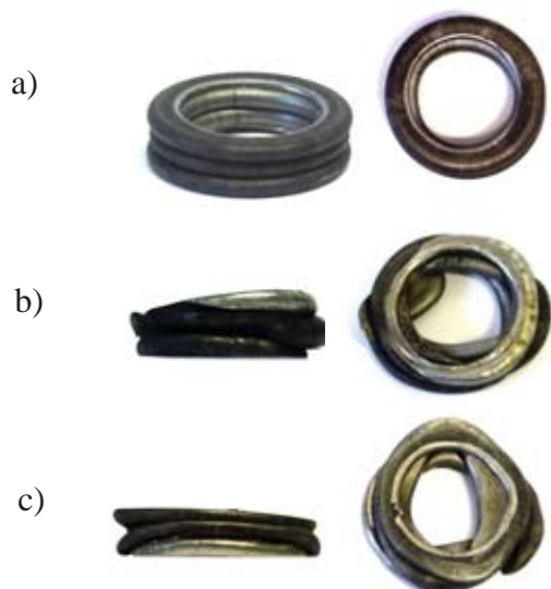
Rys. 7. Postać deformacji próbek przy obciążeniu statycznym(a) i dynamicznym (b, c) Fig. 7. Deformation mode of specimens for static (a) and dynamic (b, c) loads
