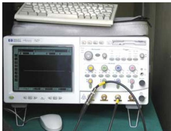
Rys. 3. Oscyloskop cyfrowy umożliwiający zapis wyników pomiaru z częstotliwością 2,5 MHz
