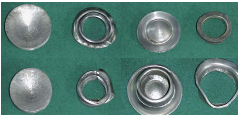
Rys. 6 Sposób deformacji próbek cylindrycznych i krążków przykrywających poddanych obciążeniom falą powstałą w wyniku detonacji ładunków wybuchowych o masach 20-30 gramów
