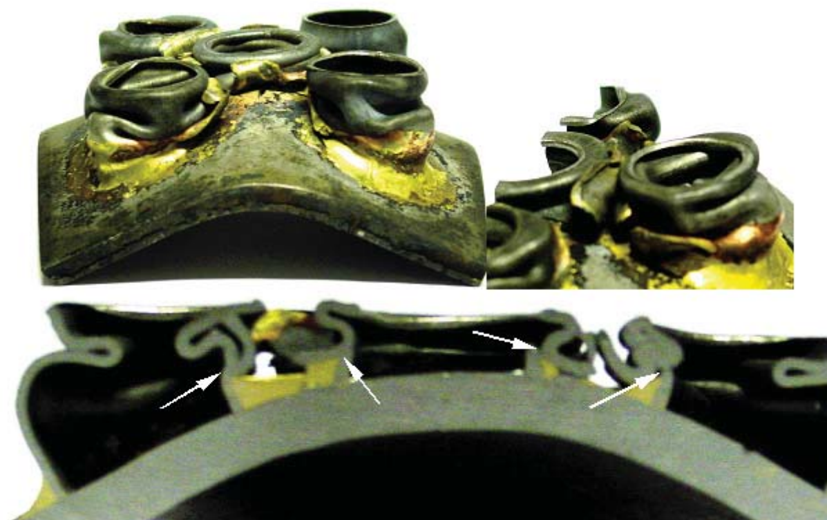
Rys. 14. Deformacja pakietu 5-elementowego przy ładunku 40g MW (przekrój) Fig. 14. Deformation of set of 5 cylindrical tubes loaded by blast wave of 40g charge explosion
