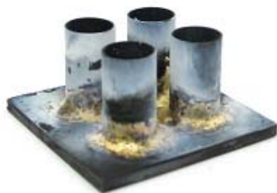
Rys. 1. Pakiet ochronny zawierający 4 (a) lub 5 (b) elementów cylindrycznych Fig. 1. Set of 4 (a) and 5 (b) cylindrical tube elements
