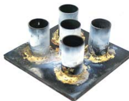
Rys. 1. Pakiet ochronny zawierający 4 (a) lub 5 (b) elementów cylindrycznych Fig. 1. Set of 4 (a) and 5 (b) cylindrical tube elements
