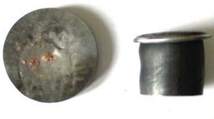
Rys. 8. Deformacja elementu cylindrycznego \phi 32 \times 1,5 mm Fig. 8. Deformation of \phi 32 \times 1,5 mm cylindrical tube
