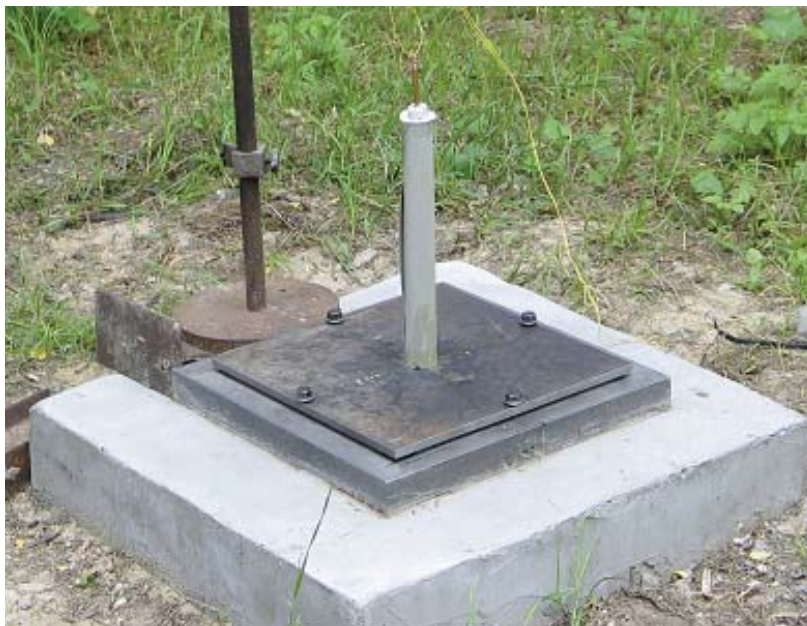
Rys. 4. Realizacja wybuchu powietrznego w odległości 300mm od płyty Fig. 4. Detonation of the charge situated 300mm away
