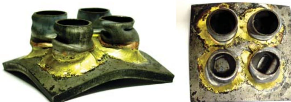
Rys. 11. Deformacja pakietu 4-elementowego przy ładunku 30g MW Fig. 11. Deformation of set of 4 cylindrical tubes loaded by blast wave of 30g charge explosion
