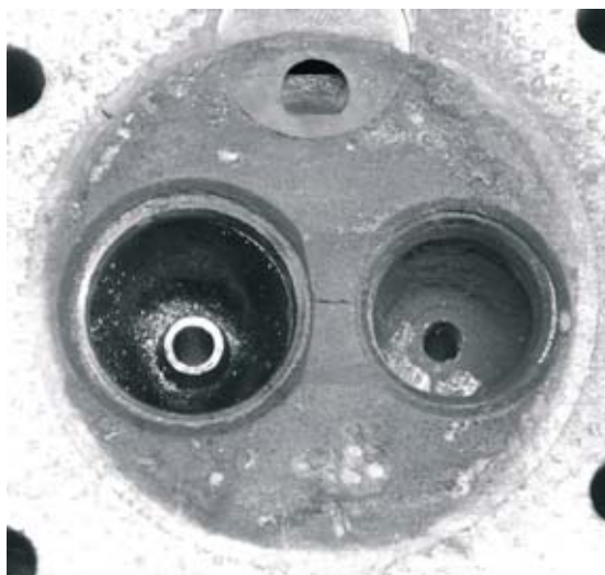
Rys. 1. Widok pękniętej głowicy silnika 4C90 Fig. 1. View of cracked engine head of 4C90 engine
