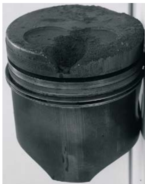
Rys 3. Widok uszkodzonego tłoka Fig. 3. View of damaged piston
