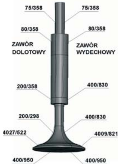
Rys. 1 Warunki brzegowe dla zaworów Fig. 1 Boundary conditions for valves
