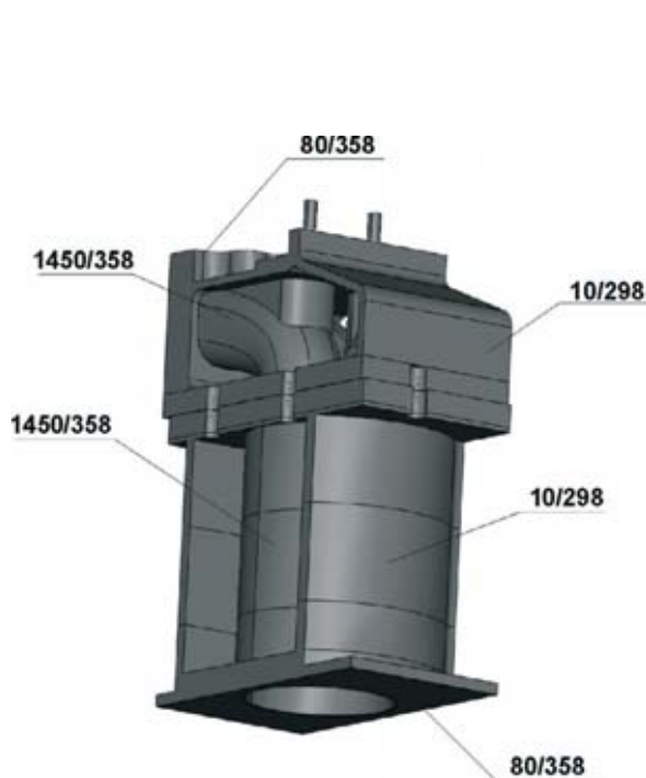
Rys. 3 Warunki brzegowe dla silnika Fig. 3 Boundary conditions for engine
