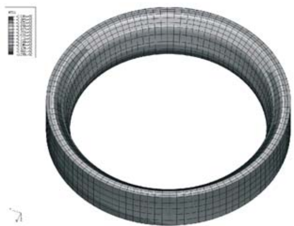
Rys. 8. Rozkład temperatury w gnieździe wydechowym Fig. 8. Temperature distribution in exhaust insert
