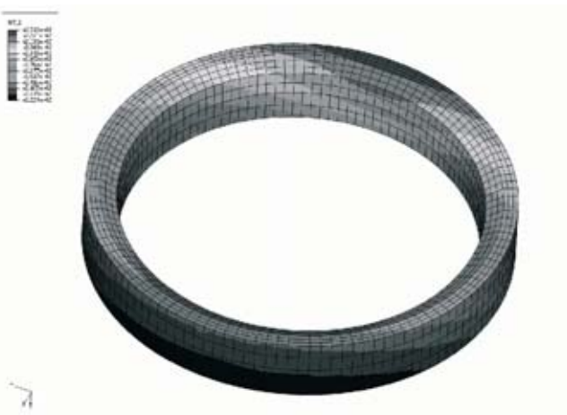
Rys. 7. Rozkład temperatury w gnieździe ssącym Fig. 7. Temperature distribution in inlet insert
