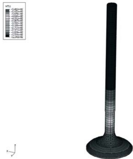
Rys. 6. Rozkład temperatury w zaworze wylotowym Fig. 6. Temperature distribution in exhaust valve
