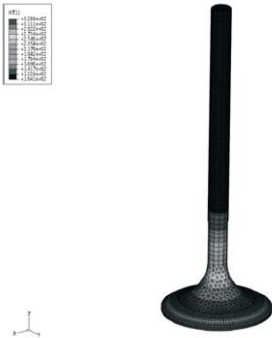
Rys. 5. Rozkład temperatury w zaworze dolotowym Fig. 5. Temperature distribution in inlet valve
