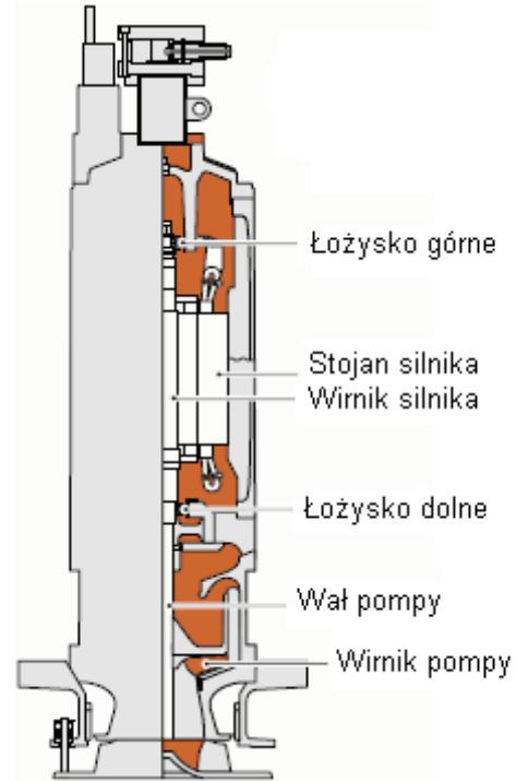
Rys. 5. Widok i przekrój pompy zasilającej LNG [2] Fig. 5. Section and view of feed pump [2]
