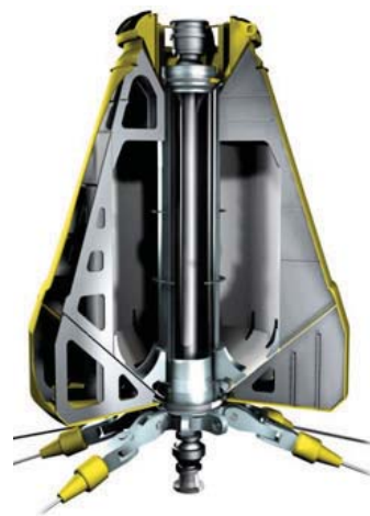
Rys. 2. Boja STL [1] Fig. 2. STL buoy [1]
