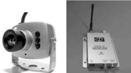
Fot. 3. Wygląd zestawu bezprzewodowej kamery 208C wraz z odbiornikiem [2] Pic. 3. Appearance of the set of the cordless 208C camera together with the receiver [2]
