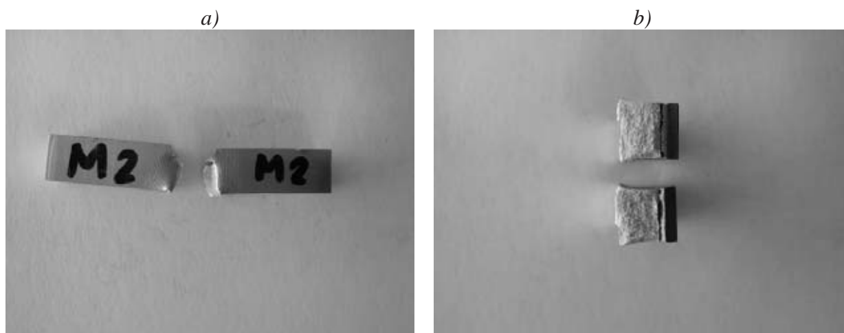
Fig. 3. General sight of MIG specimen after impact resistance test Rys. 3. Widok ogólny próbki spawanej MIG po próbie udarności
