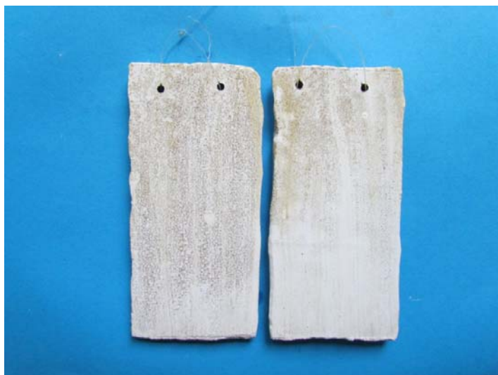
Fot. 2. Powłoka z farby nr 1 – po sztucznym starzeniu i badaniach biologicznych Photo 2. The cover from paint no 1 – after artificial weathering and microbiological tests
