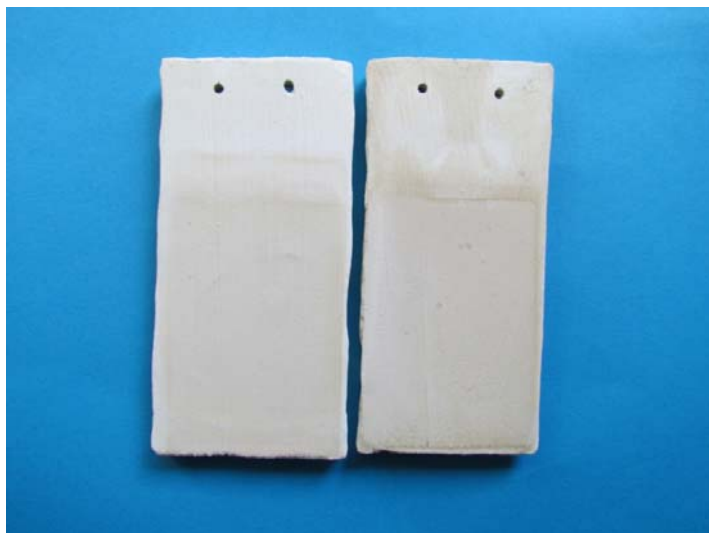
Fot. 3. Powłoka z farby nr 2 – po sztucznym starzeniu i badaniach biologicznych Photo 3. The cover from paint no 2 – after artificial weathering and microbiological tests
