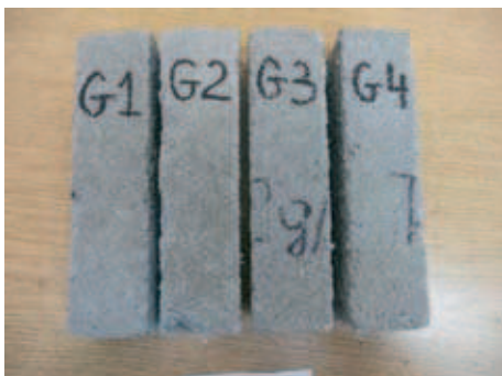
Rys. 2. Wycięte z jednego podkładu beleczki 4x4x16 cm
