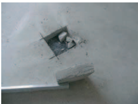
Rys. 1. Pobrany fragment podkładu do badań niszczących
