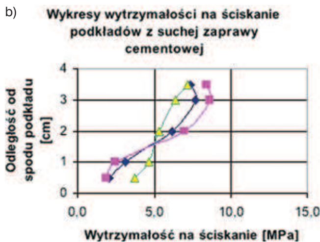
Rys. 10. Rozkład wytrzymałości na grubości różnych podkładów: a) podkłady wykonane z plastycznej zaprawy, z dużą ilością wody, b) podkłady wykonane z suchej zaprawy słabo zagęszczonej [5, 6]
