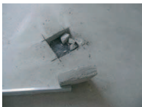
Rys. 1. Pobrany fragment podkładu do badań niszczących
