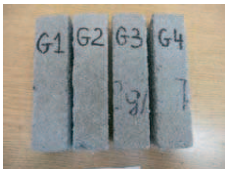
Rys. 2. Wycięte z jednego podkładu beleczki 4x4x16 cm
