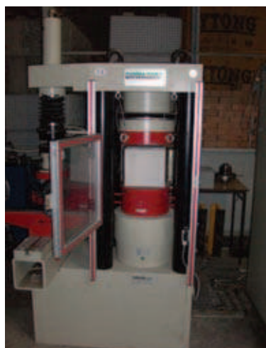
Rys. 1. Badanie wytrzymałości na ściskanie elementów murowych
