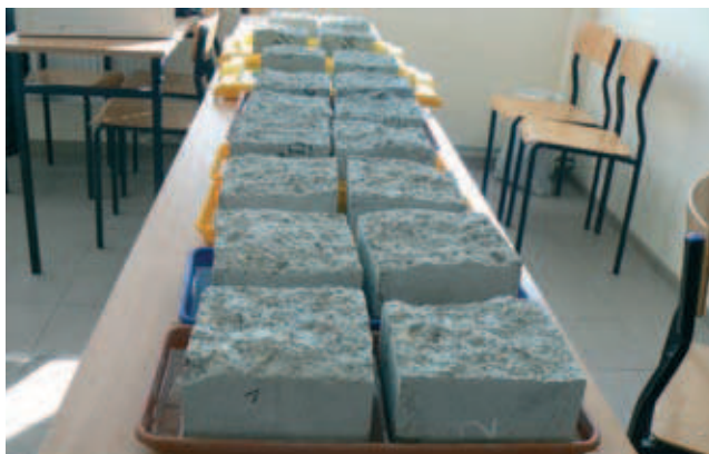
Rys. 1. Badanie sorpcyjności metodą masową
