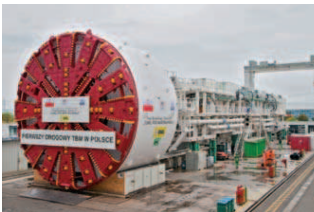
Fot. 7. Maszyna TBM do drążenia tunelu, Trasa Słowackiego, zadanie 4
