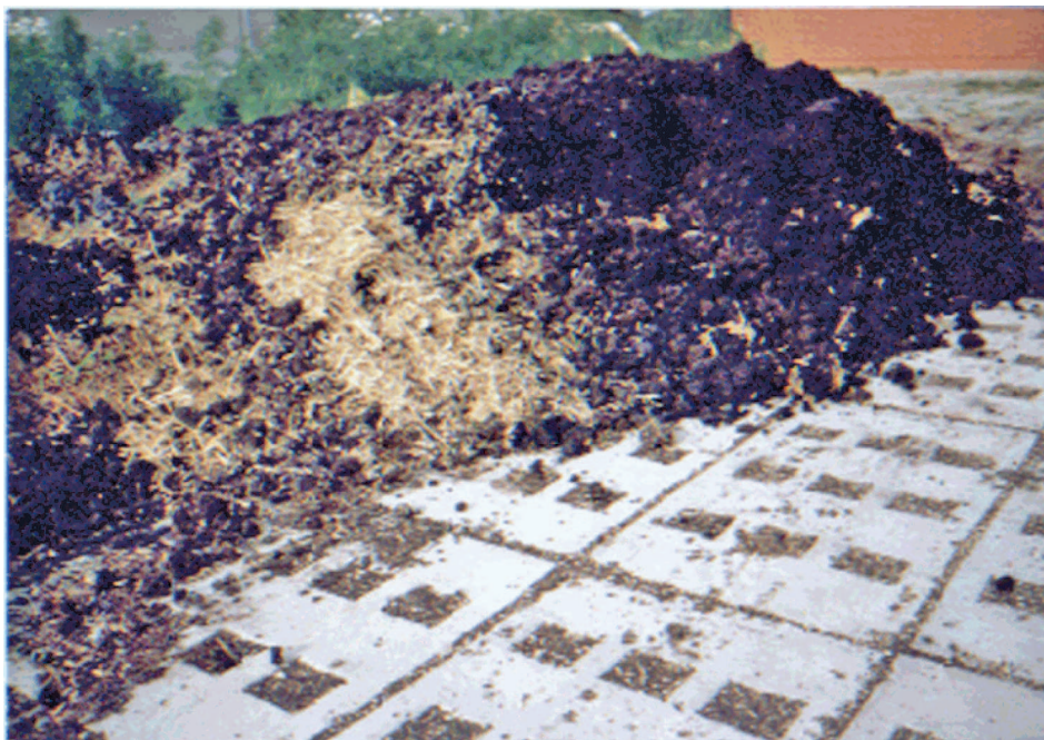
Ryc. 1. Wstępne leżakowanie osadów z materiałem strukturotwórczym w Oczyszczalni Ścieków w Kluczborku
