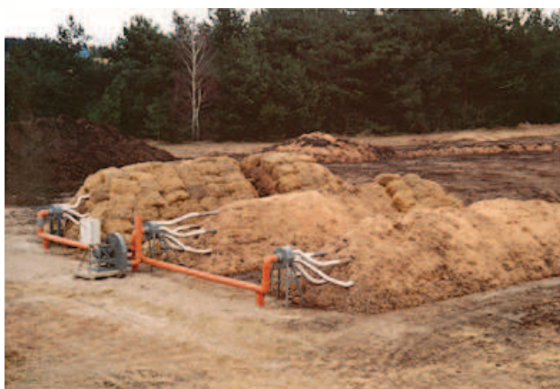
Ryc. 2. Układ napowietrzania pryzm z osadów ściekowych firmy GWDA [8]
