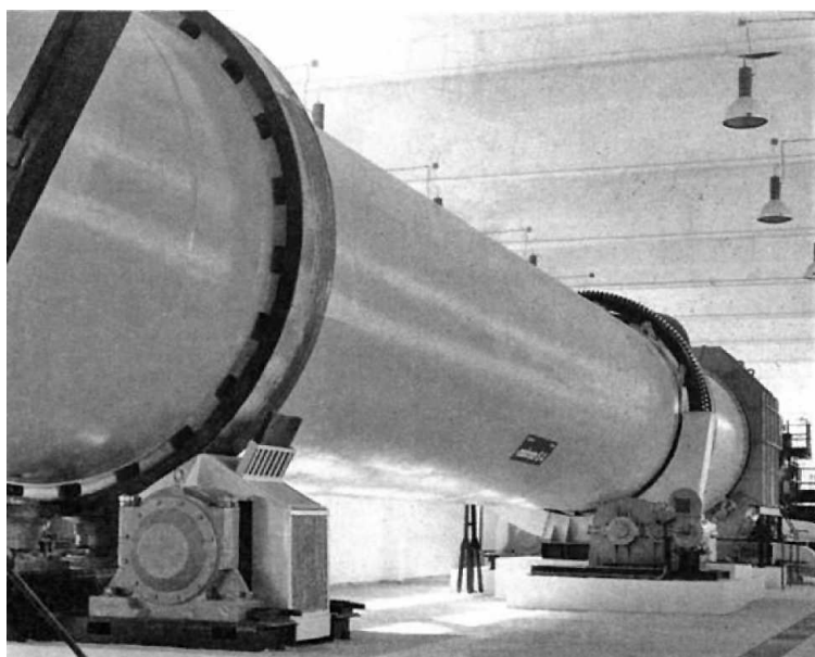
Ryc. 5. Biostabilizator – widok od strony załadunku [14]
