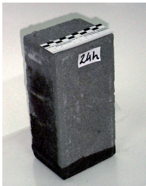
Fot. 3. Wynik badania podciągania kapilarnego kostki po 24 godz.
