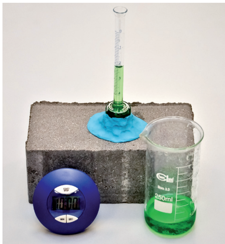
Fot. 4. Metoda Karstena – badanie wnikania wody w głąb kostki brukowej
