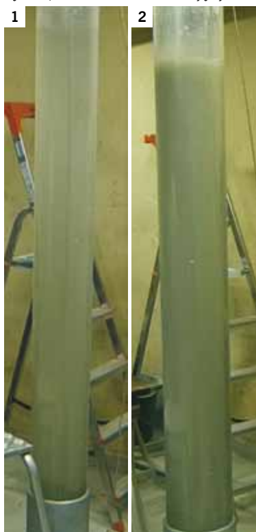
Rys. 2. Tuby po badaniach wyfukalności zaczynu z mieszanek betonowych: 1) z domieszką UWC; 2) bez domieszki stabilizującej
