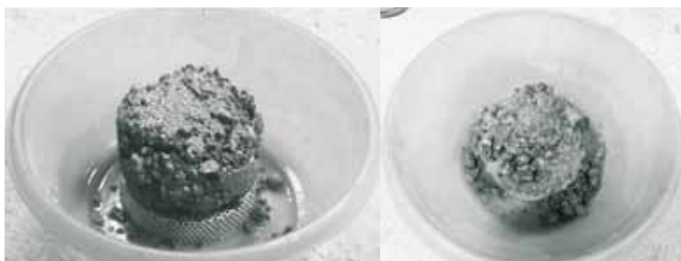
Rys. 3. Zdjęcia próbek mieszanki betonowej po badaniu strat wyfukania metodą CRD-C61-89A: z lewej próbka mieszanki z domieszką podwodną, z prawej próbka mieszanki bez domieszki podwodnej
