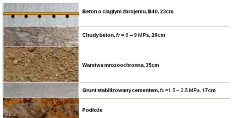
Rys. 5. Przekrój konstrukcji nawierzchni o ciągłym zbrojeniu
