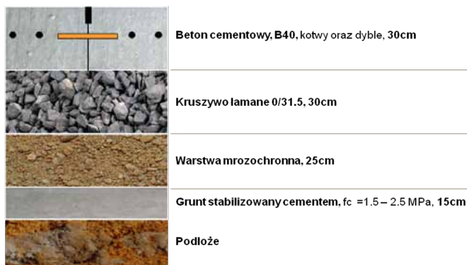
Rys. 9. Przekrój nawierzchni z podbudową z kruszywa
