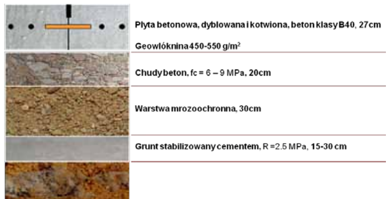
Rys. 3. Szczegół konstrukcji nawierzchni autostrady A4
