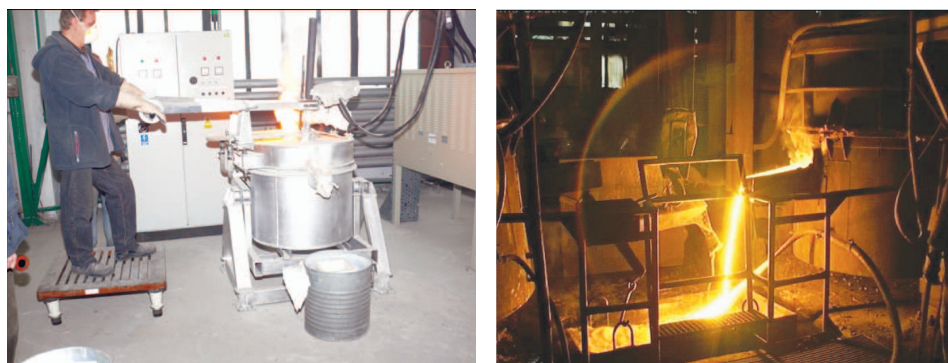
Ryc. 2. Próby topienia i odlewania eternitu
