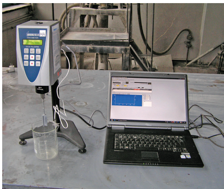
Ryc. 4. Lepkościomierz cyfrowy firmy Brookfield typu DV – II + PRO przygotowany do badania i rejestracji lepkości próbki
