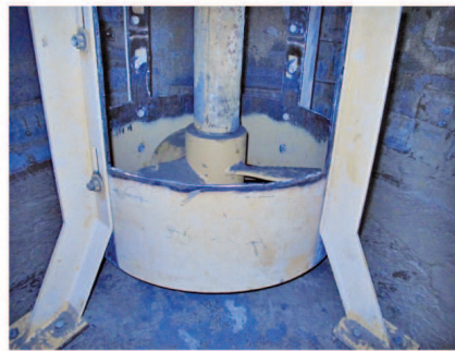
Ryc. 9. Wnętrze mieszalnika: a) – z mieszadłem wirnikowym, b) – z mieszadłem śmigłowym
