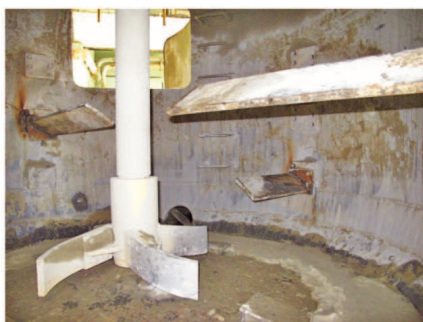
Ryc. 9. Wnętrze mieszalnika: a) – z mieszadłem wirnikowym, b) – z mieszadłem śmigłowym
