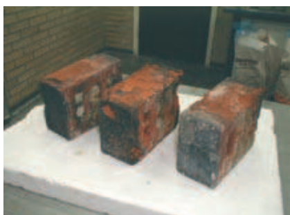
Rys. 8–9. Badanie cegieł kominowych pobranych z analizowanego komina
