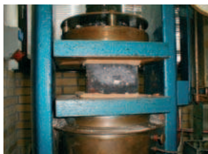
Rys. 8–9. Badanie cegieł kominowych pobranych z analizowanego komina
