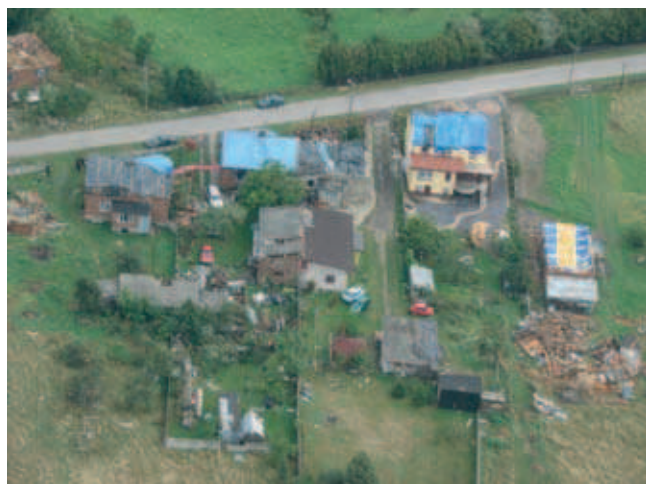
Fot. 1. Zdjęcie lotnicze obrazujące zniszczenia części budynków po wichurze w 2008 roku w województwie łódzkim
