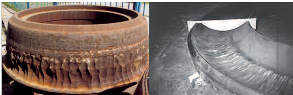
Ryc. 2. Zużyte elementy mielące: a) rolka, b) misa [14]
