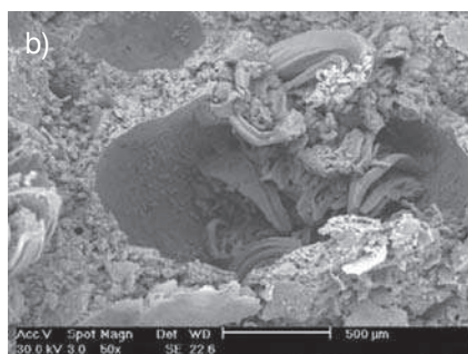
Rys. 8. Makropory w tynku MAPE-ANTIQUE (a). Krystalizacja soli wewnątrz porów (b)
