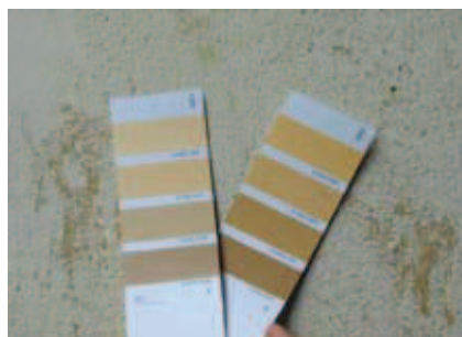
Rys. 11. Wstępny dobór koloru masy tynkarskiej SILANCOLOR TONACHINO, na podstawie pierwotnej kolorystyki elewacji obiektu
