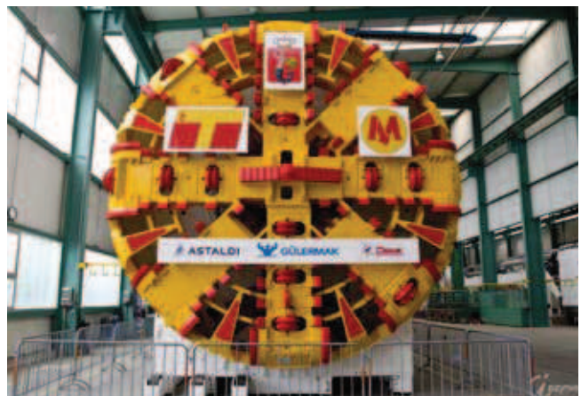
Rys. 3. TBM do drążenia tuneli metra w Warszawie. Fot.: inzynieria.com
