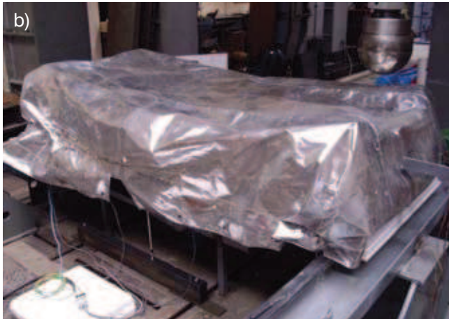
Rys. 9. Stanowisko do badań termicznych: a) układ grzałek, b) folia zabezpieczająca przed odpływem ciepła
