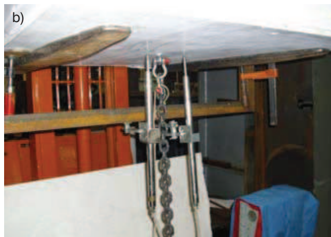
Rys. 10. Stanowisko do badań wytrzymałości na obciążenia przedmiotami mocowanymi do panelu: a) badanie na ścianie, b) badanie na połówce panelu
