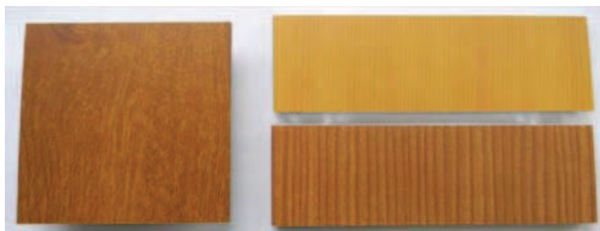
Rys. 2. Powłoki dekoracyjne z efektem drewna wykonane techniką sublimacji
