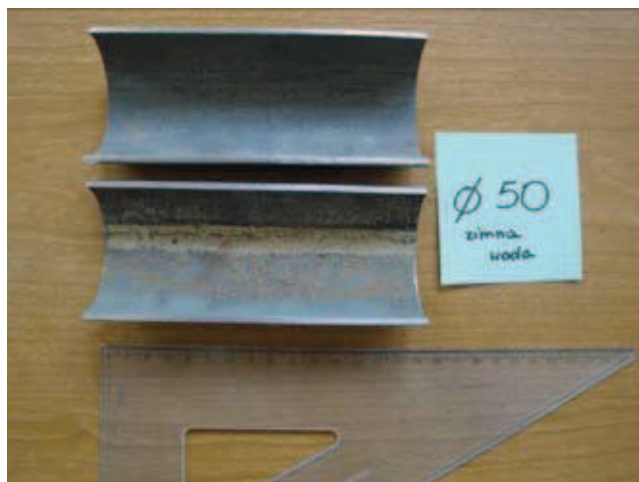
Rys. 1. Wżery w rurach transportujących zimną wodę
