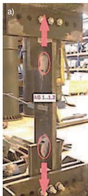
Rys. 6. Badania nośności spoin pachwinowych w połączeniach widelkowych: a) model połączenia podczas próby rozciągania, b) spoiny W1, W2 w badanych modelach.
