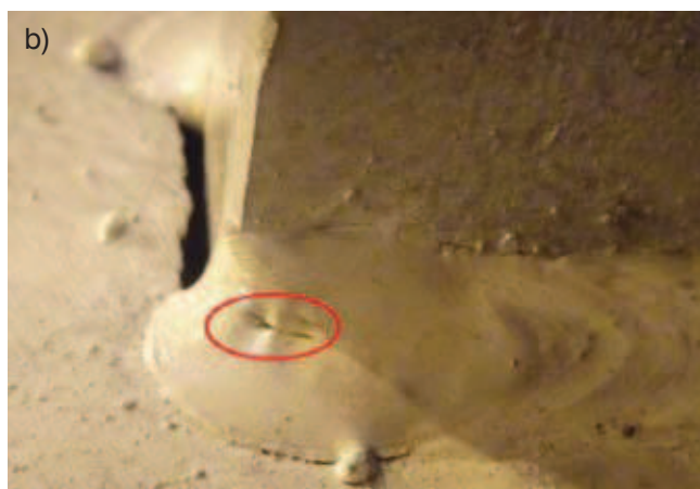
Rys. 7. Pęknięcia spoin pachwinowych w badanych połączeniach widelkowych płaskowników: a) w spoinie poprzecznej W2, b) w kraterze spoiny podłużnej W1
