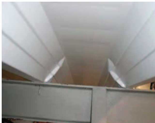
Rys. 3. Powstałe załomy plastyczne w fazie końcowej dla modelu P12.6
