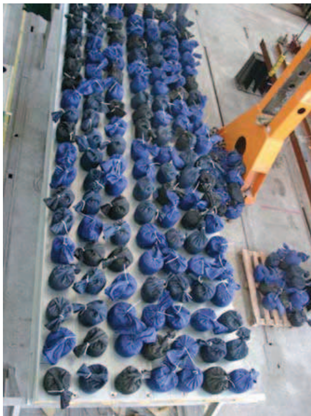
Rys. 2. Symulowane obciążenie równomierne workami wypełnionymi piaskiem
