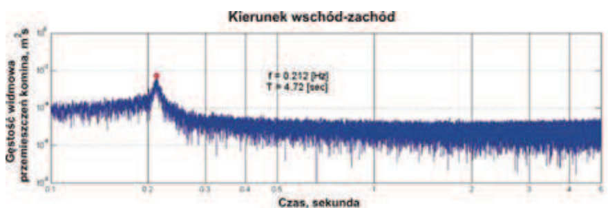
Rys. 4. Wykres funkcji gęstości widmowej odpowiedzi komina Elektrowni Bełchatów w kierunku wschód-zachód w punkcie pomiarowym na wysokości 297 m
