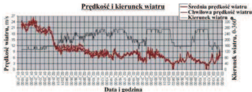
Rys. 2. Prędkość i kierunek wiatru uzyskane z przenośnej stacji meteorologicznej na stopniu zwieńczającym komin w dniach 1–3 grudnia 2008 r.
