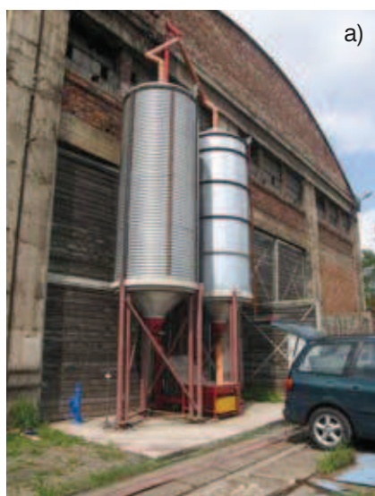
Rys. 5. Badane silosy w skali naturalnej (a) oraz schemat pionowego obciążenia F_b i G_L lejów w badanych silosach (b)
