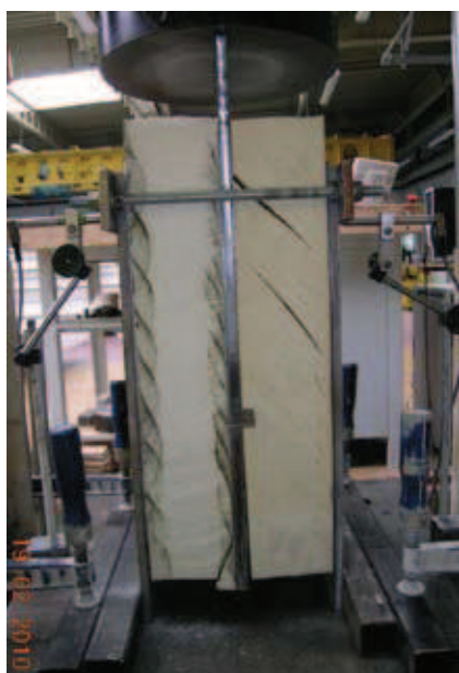
Rys. 5. Bezpośrednie ścinanie próbki podwójnej
