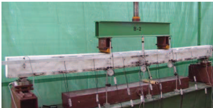
Rys. 1. Widok ogólny stanowiska podczas badania belki B-2 (seria B)
