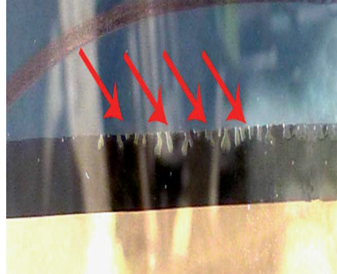
Ryc. 2. Występowanie pęcherzy w szczeliwie
