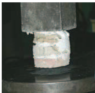
Rys. 3. Badania próbek walcowych wykonanych z połączonych między sobą krążków zaprawy o grubości h_m : 1 – zaprawa, 2 – spoiwo łączące
