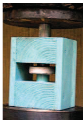
Rys. 2. Badanie zaprawy pobranej ze spoin wspornych o grubości h_m wg normy DIN 18555-9:1999-09: 1 – zaprawa, 2 – filc lub gips, 3 – stalowe elementy dociskowe o średnicy 20–25 mm
