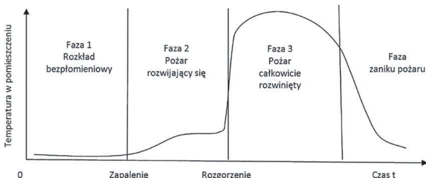
Rys. 3. Różne fazy przebiegu pożaru w pomieszczeniach. Źródło: opracowanie własne na podstawie PN-EN 60695-7-1:2010 Toksyczność lotnych produktów spalania – wytyczne ogólne [12]
