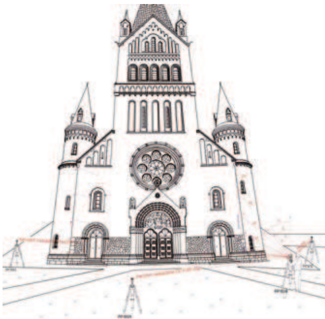
Rys. 2. Technologia pomiaru deformacji wybranych elementów kościoła pw. ZNMP w Inowrocławiu – widok od strony zachodniej (ściana frontowa)
