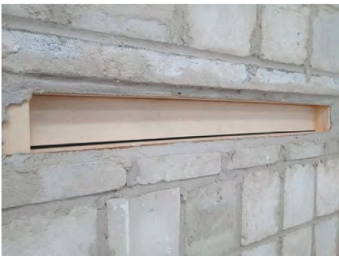
Fot. 1. Widok stanowiska badawczego do pomiaru izolacyjności akustycznej uszczelki progowych a – od strony komory nadawczej, b – od strony komory odbiorczej Photo 1. View of test arrangement for measurement of floor seals sound insulation a – from the source room, b – from the receiving room
