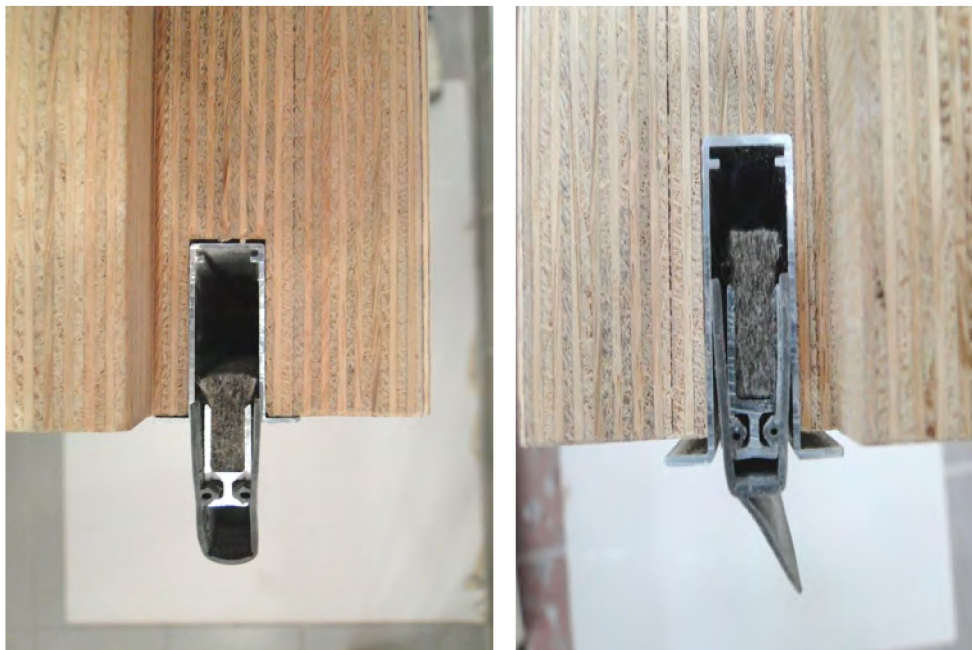
Fot. 3. Uszczelki progowe badane w ramach badań testujących stanowiska Photo 3. Floor seals investigated within the testing of test arrangement
