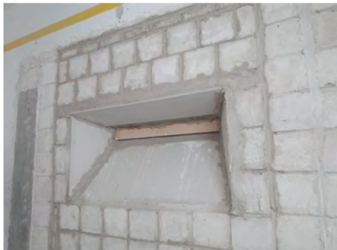
Fot. 1. Widok stanowiska badawczego do pomiaru izolacyjności akustycznej uszczelki progowych a – od strony komory nadawczej, b – od strony komory odbiorczej Photo 1. View of test arrangement for measurement of floor seals sound insulation a – from the source room, b – from the receiving room
