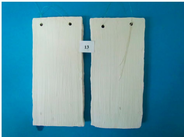
Fot. 3. Powłoka z farby nr 13 – widoczny brak wzrostu pleśni na próbce Photo. 3. The cover from paint no 13, no mould growth on the sample observed
