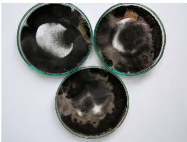
Fot. 4. Powłoka z farby nr 13 – widoczny intensywny wzrost pleśni na próbce Photo. 4. The cover from paint no 13, intensive mould growth is visible on the sample
