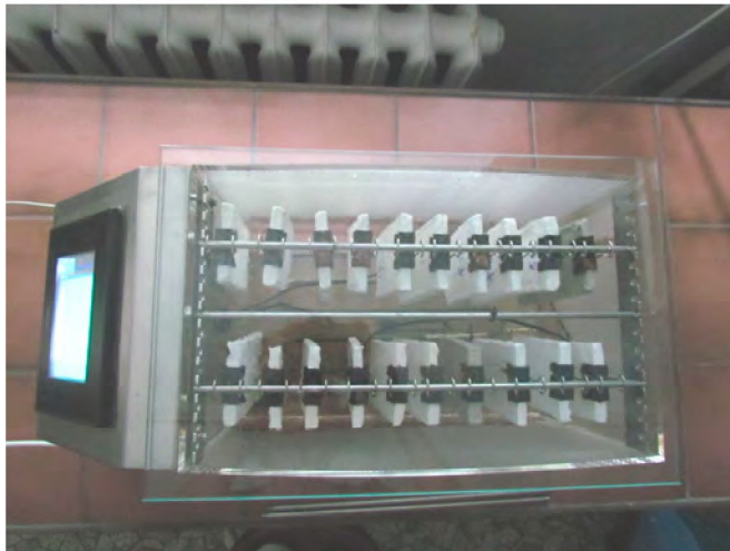
Fot. 2. Widok urządzenia z góry. Widoczny sposób mocowania próbek Photo 2. The view of device from the top. The manner of fastening the shelves is visible
