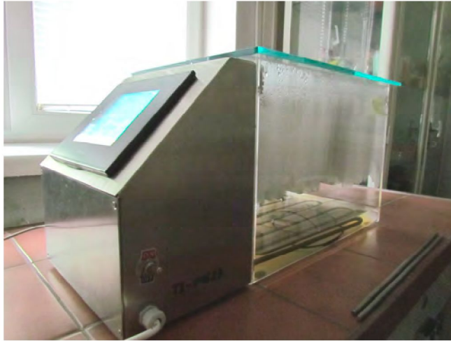
Fot.1. Urządzenie do badania odporności powłok na działanie grzybów pleśniowych Photo 1. The device for resistance researches of covers for mould fungus activity
