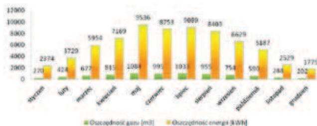
Rys. 8. Wykres oszczędności gazu i energii do ogrzania ciepłej wody, po zastosowaniu instalacji solarnej w analizowanym wysokim budynku punkowym
