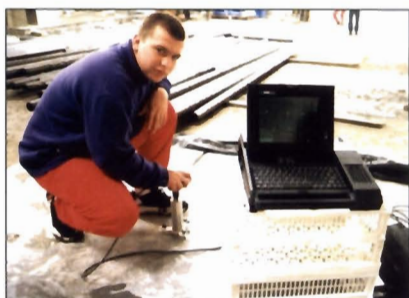
Fot. 6. Przykład wykorzystania metody „Impact-Echo” do nieniszczącego pomiaru grubości posadzki betonowej
