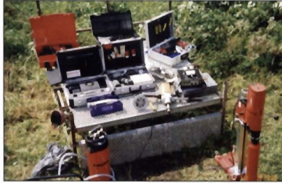
Fot. 1. Przykładowy zestaw aparatury do nieniszczącej diagnostyki konstrukcji betonowych
