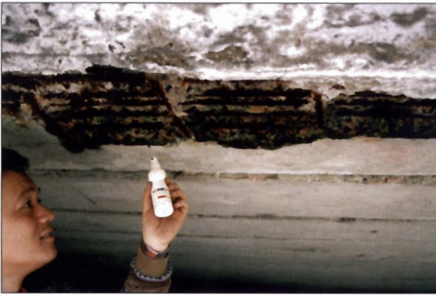
Fot. 3. Przykład zastosowania „Rainbow-Testu” do oceny stopnia karbonatyzacji przekroju betonowego
