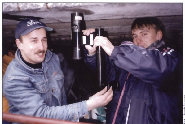
Fot. 2. Pomiar wytrzymałości betonu na ściskanie metodą „pull-out”
