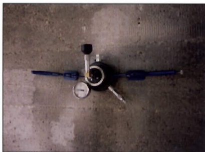
Fot. 5. Widok pomiaru wodoszczelności betonu za pomocą komory ciśnieniowej GWT
