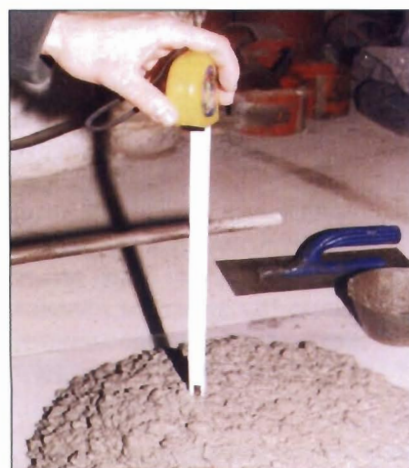
Fot. 2: Pomiar konsystencji mieszanki betonowej ASCC na stanowisku formowania
