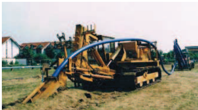
Rys. 1. Pługoukładacz z napędem własnym do wbudowywania przewodów podziemnych (zdjęcie własne)
