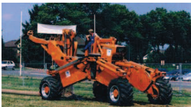
Rys. 2. Pługoukładacz przeciągany ciągnikiem przy pomocy liny i wciągarki (zdjęcie własne)
