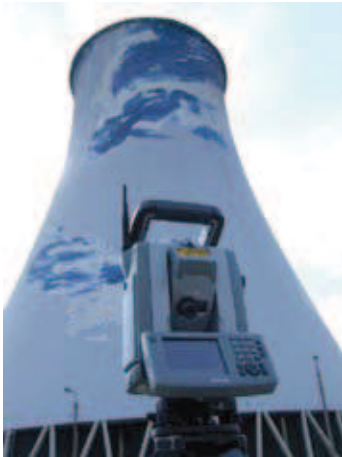
Rys. 2. Widok chłodni hiperboloidalnej nr 2 Elektrociepłowni „Kraków” – inwentaryzacja tachimetrem skanującym VX firmy Trimble
