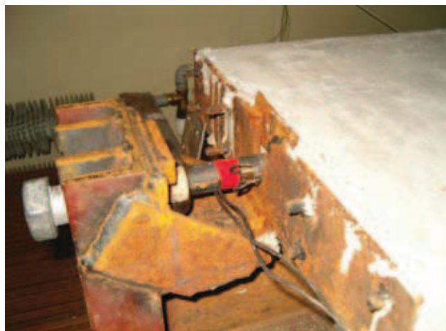
Rys. 4. Rozwiązanie konstrukcyjne belki zespolonej: a) widok belki zespolonej, b) widok śrubowego urządzenia sprężającego
