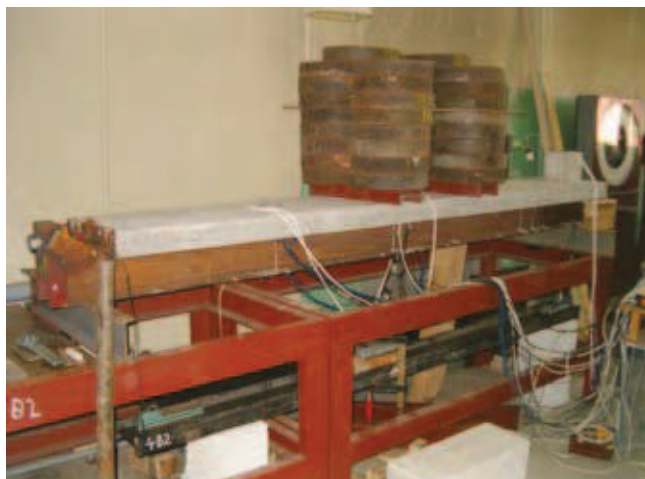
Rys. 4. Rozwiązanie konstrukcyjne belki zespolonej: a) widok belki zespolonej, b) widok śrubowego urządzenia sprężającego
